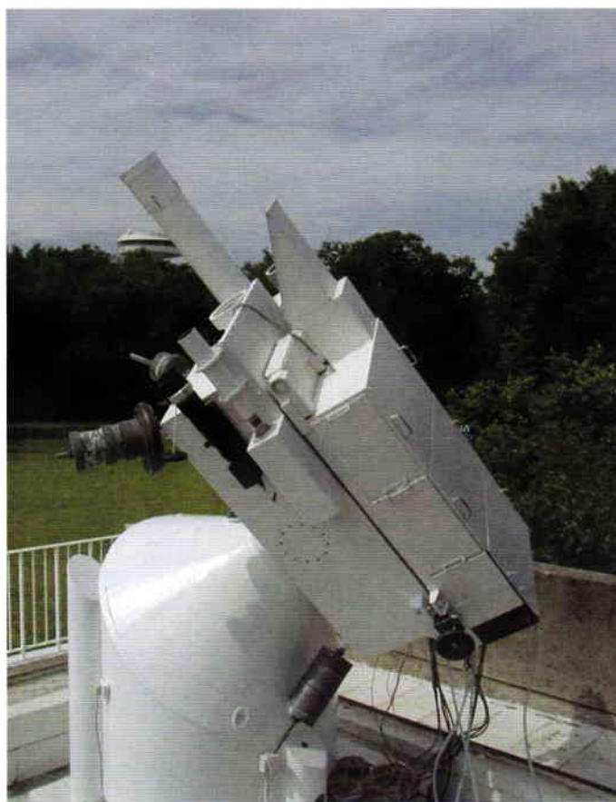
L'héliographe monochromatique de Lyot pour la surveillance cinématographique des centres actifs solaires.
